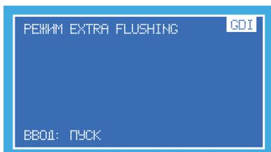
5. Процедура займет 16 мин и закончится автоматически. После завершения промывки стенд автоматически сбросит давление в системе и подаст звуковой сигнал.
