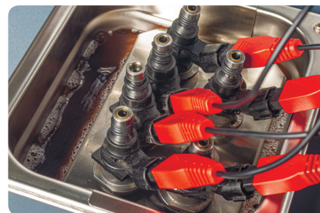
Промывка форсунок в УЗ ванне
